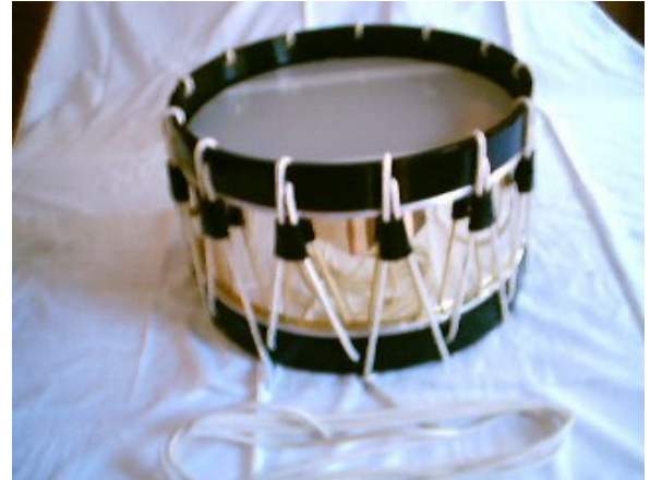
Étape 7 : pose de la corde et des tirants (+ crochets si montage "à crochets" )
