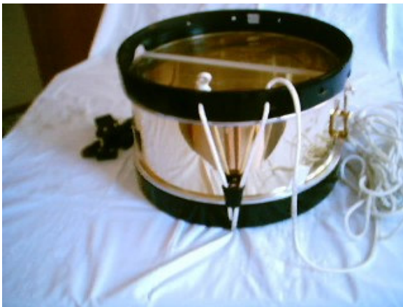
Étape 7 : pose de la corde et des tirants (+ crochets si montage "à crochets" )
