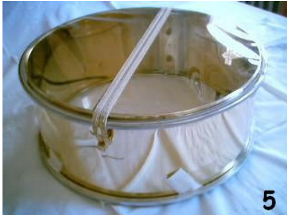
Étape 5 : pose des cordes de timbre
